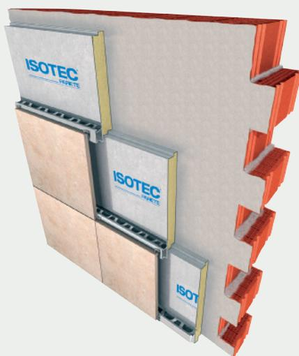
preaccoppiato in stabilimento. Una soluzione che permette di realizzare rapidamente e con semplicità un impalcato portante, termoisolante e ventilato. Il correntino asolato, una volta posato il rivestimento esterno, fa in modo che si generi un'efficace camera di areazione, svolgendo nello stesso tempo la funzione di ottimale supporto per il rivestimento.
