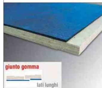
membrana fonoisolante Gumacustik a base di polimeri carichi, rivestita su entrambi i lati di TNT. La linea Cartongum è una linea di isolanti acustici a basso spessore ed elevate prestazioni, studiati appositamente per essere applicati a parete e a soffitto su struttura metallica da cartongesso o con gli appositi profili per l'insonorizzazione di edifici esistenti. Cartongum può essere impiegato anche in intercapedini ove ci sia poco spessore a disposizione.
